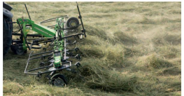
Une position transport compacte. Malgré sa largeur de travail de 8m la CondiMaster 8022 se replie de façon très compacte pour le transport, et est inférieure à 3,00m de large.
