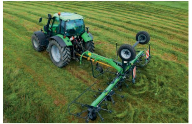
Avec la mise en oblique, le fourrage est ramené vers l'intérieur de la parcelle. Elle est commandée hydrauliquement depuis le poste de conduite. La solution idéale pour travailler le long des bordures.
