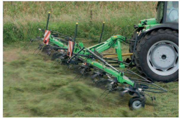
Avec la mise en oblique le fourrage est ramené vers l'intérieur de la parcelle. Elle est commandée hydrauliquement depuis de poste de conduite. La solution idéale pour travailler le long des bordures.
