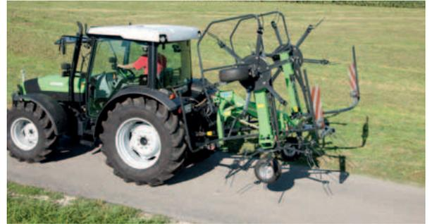
Toutes les faneuses offrent un repliage hydraulique entre la position de travail et la position de transport, et inversement.
