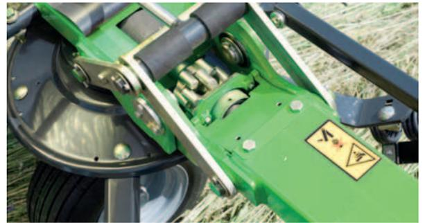
Entraînement à doigts HexaLink permettant un repliage au transport à 180°.
