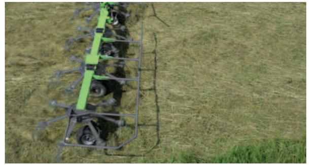
Pour le fanage des bordures les 2 rotors extérieurs se pivotent.
