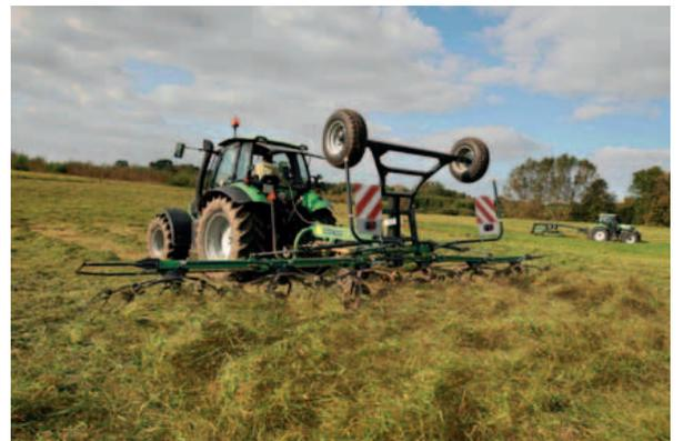
La CondiMaster 7641 est équipée d'un chariot de transport intégré permettant une utilisation par des tracteurs de faible puissance.
