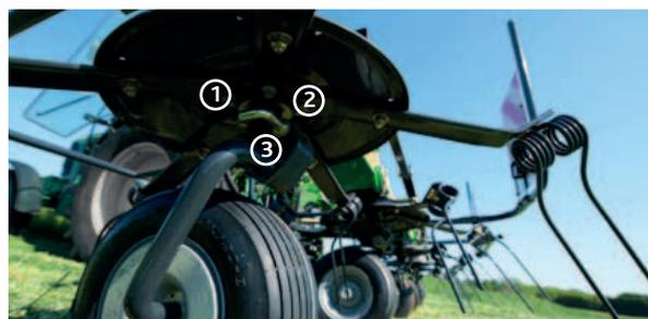
Le réglage de l'angle de travail par un levier 3 positions permet une adaptation à tous les types de fourrage, un séchage plus rapide et des pertes minimisées.
