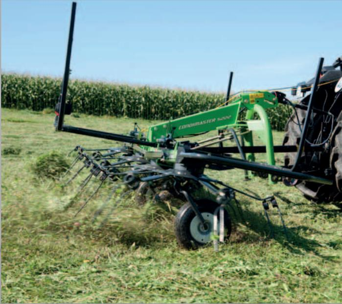
Les CondiMaster 4622, 5222, 6022 et 8022 sont entraînées par des boîtiers avec un faible niveau de maintenance. Le montage par double roulement du couple conique assure une longévité accrue de l'ensemble.
