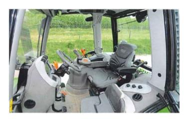
La visibilité est bonne en dépit des 6 montants. Néanmoins, de nombreux détails à l'intérieur de la cabine doivent être améliorés. Le niveau de bruit de 76,6 dB(A) constitue un record. Photo : Tovornik, opérateurs
