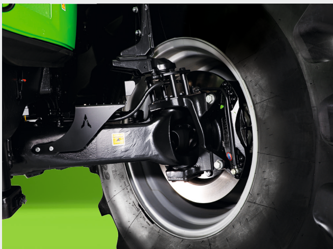
↑ Freins à disque secs pour des performances maximales.
