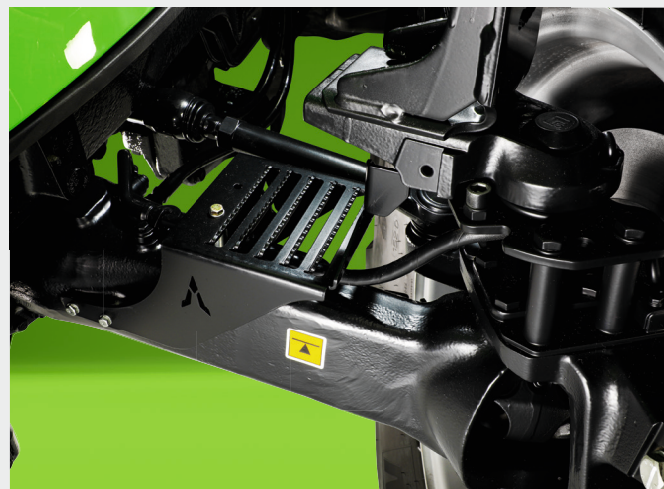
↑ Marchepieds d'entretien au-dessus du pont avant pour un nettoyage confortable.
