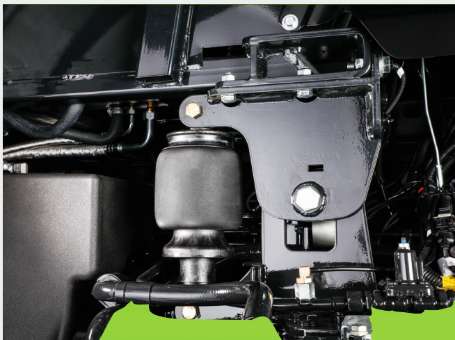
↑ Suspension pneumatique de cabine pour une conduite plus souple.
