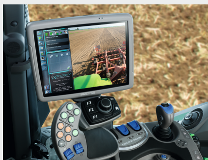
↑ Caméra intégrée avec mode plein écran automatique (par ex. en marche arrière) pour une vue d'ensemble claire et sûre.
