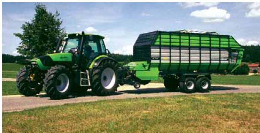
Transport sur route. Avantages de l'ASM: vitesse supérieure à 15 km/h: pont AV désactivé; vitesse inférieure à 14 km/h: traction avant activée.
