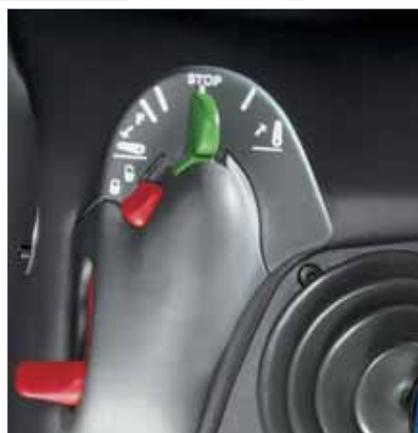
Le relevage arrière et les distributeurs auxiliaires 1+2 se pilotent directement au moyen du levier PowerCom S sur la version Profiline
