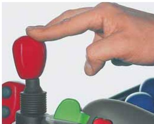
Un levier situé dans l'accoudeur multifonction permet de passer facilement les rapports sous charge.
