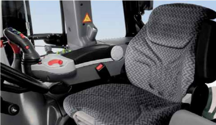
Le siège grand confort de type pneumatique dispose de onze fonctions et réglages différents, ce qui permet à chaque conducteur de trouver la position qui lui convient.
