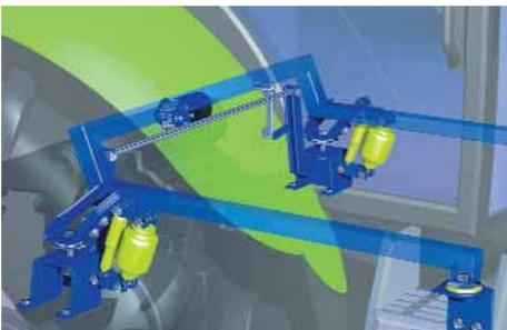
Un confort de conduite extraordinaire grâce à la cabine à suspension pneumatique.
