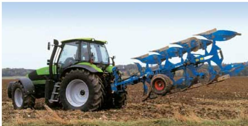
Demi-tour dans un champ. L'ASM fonctionne ainsi: angle de braquage de plus de 15°: blocages de différentiels désactivés; angle de braquage inférieur à 15°: blocages de différentiels activés; action sur les freins indépendants: blocages de différentiels désactivés.
