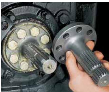
L'embout de prise de force démontable se change rapidement.
