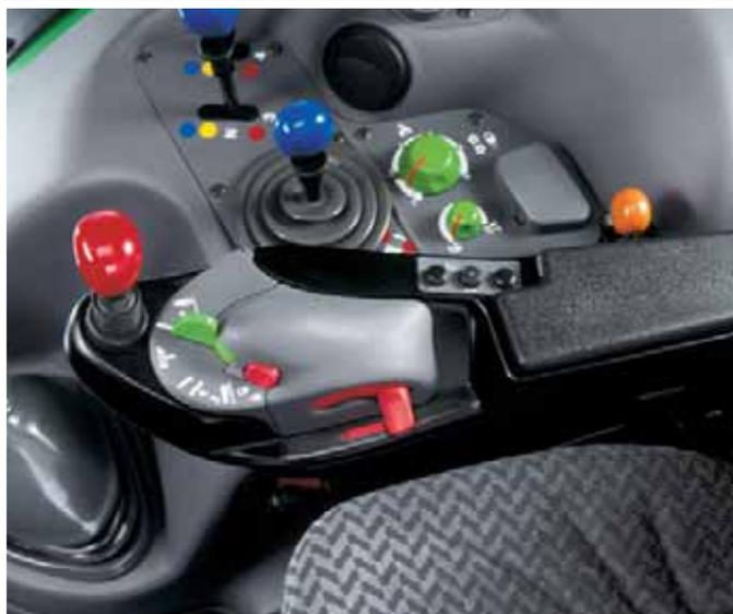
Les commandes du réglage électronique du dispositif de relevage EHR, des rapports sous charge, de l'accélérateur manuel et de la régulation électronique du moteur EMC sont intégrées dans l'accouoir multifonction optionnel.
