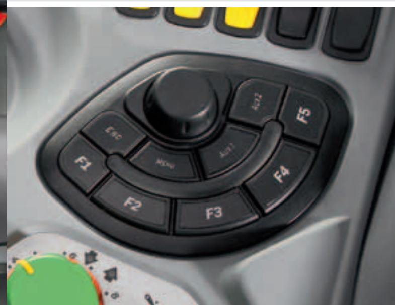
Le panneau de contrôle sur la console à droite du poste de conduite permet à l'opérateur de naviguer facilement à travers les menus à l'aide d'une manette.
