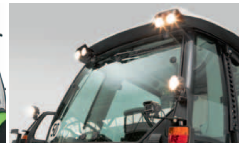
Projecteurs doubles intégrés au toit, assurant un faisceau lumineux plus large grâce à 14 puissants phares halogènes (accessoire disponible en option, également avec phares au Xénon) pour éclairer 600 m 2 de terrain.
