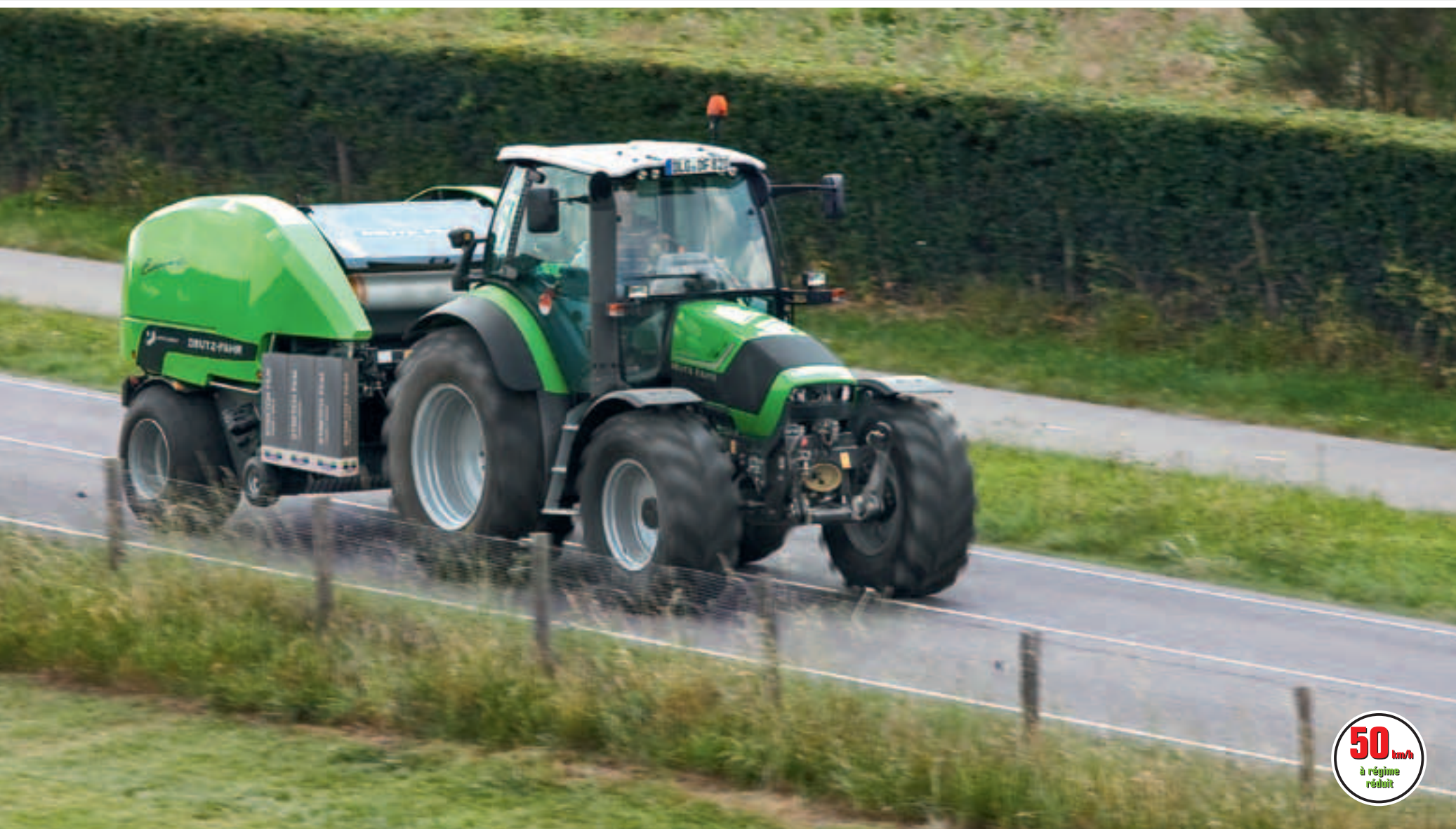
La fonction PowerZero permet de maintenir le tracteur à l'arrêt indépendamment de l'inclinaison du terrain et de la charge.
