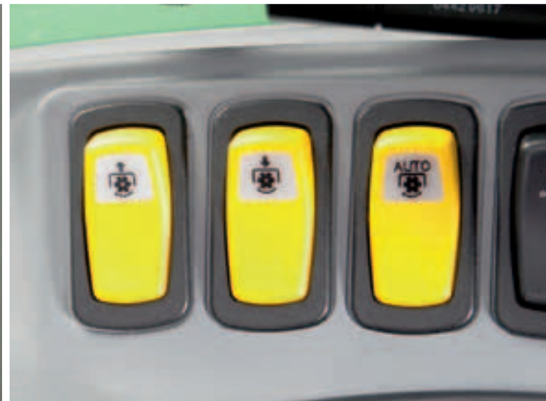
La PDF auto désactive la prise de force arrière dès que le relevage arrière est actionné.
