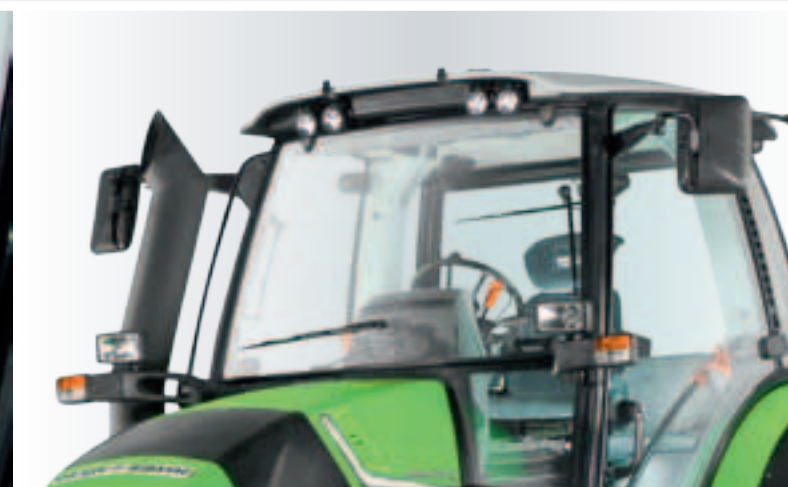
Projecteurs doubles intégrés au toit, assurant un faisceau lumineux plus large grâce à 14 puissants phares halogènes (accessoire disponible en option, également avec phares au Xénon) pour éclairer 600 m 2 de terrain.
