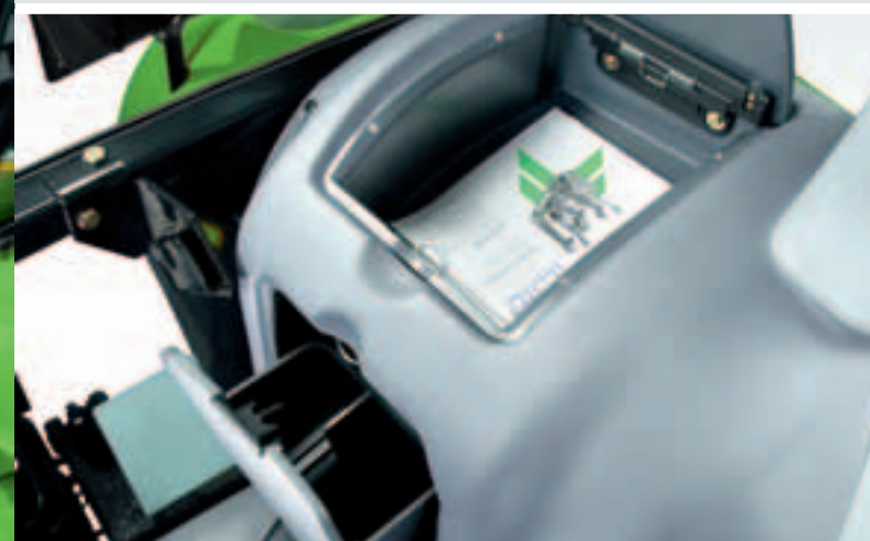
Le compartiment réfrigérateur exploite le circuit de climatisation et peut contenir 1 grande bouteille (2 litres) + 1 canette. Sa capacité de 7 dm 3 permet de contenir la trousse de premiers soins selon la norme DIN.
