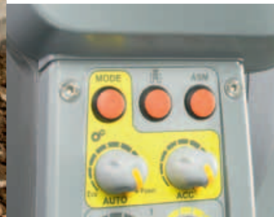
La sélection du mode de conduite a lieu dans l'accoudoir.
