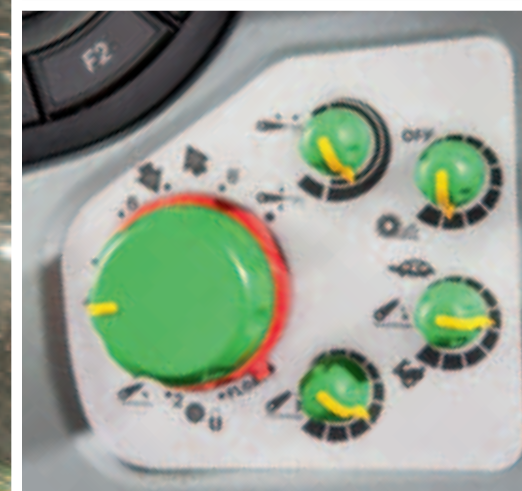
Les réglages du relevage se font sur la console latérale et un afficheur numérique sur le tableau de bord permet de visualiser les paramètres de travail.
