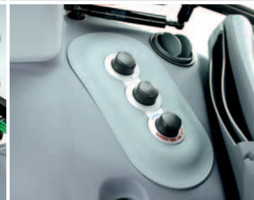
Système de ventilation de grande puissance à 4 vitesses avec débit jusqu'à 580 m 3 /h.
