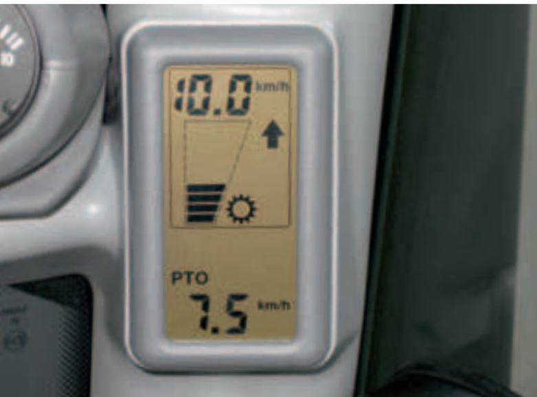
Le mode prise de force de la transmission s'active automatiquement quand la prise de force est insérée.
