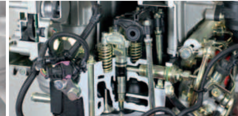
La distribution à 16 soupapes permet de parfaire le remplissage des cylindres ainsi que d'optimiser le mélange air/fioul.
