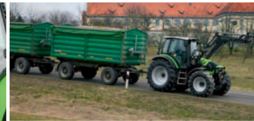
La fonction TrailerStrech est activée par un bouton dans la cabine, pour un freinage sécurisé avec une remorque.
