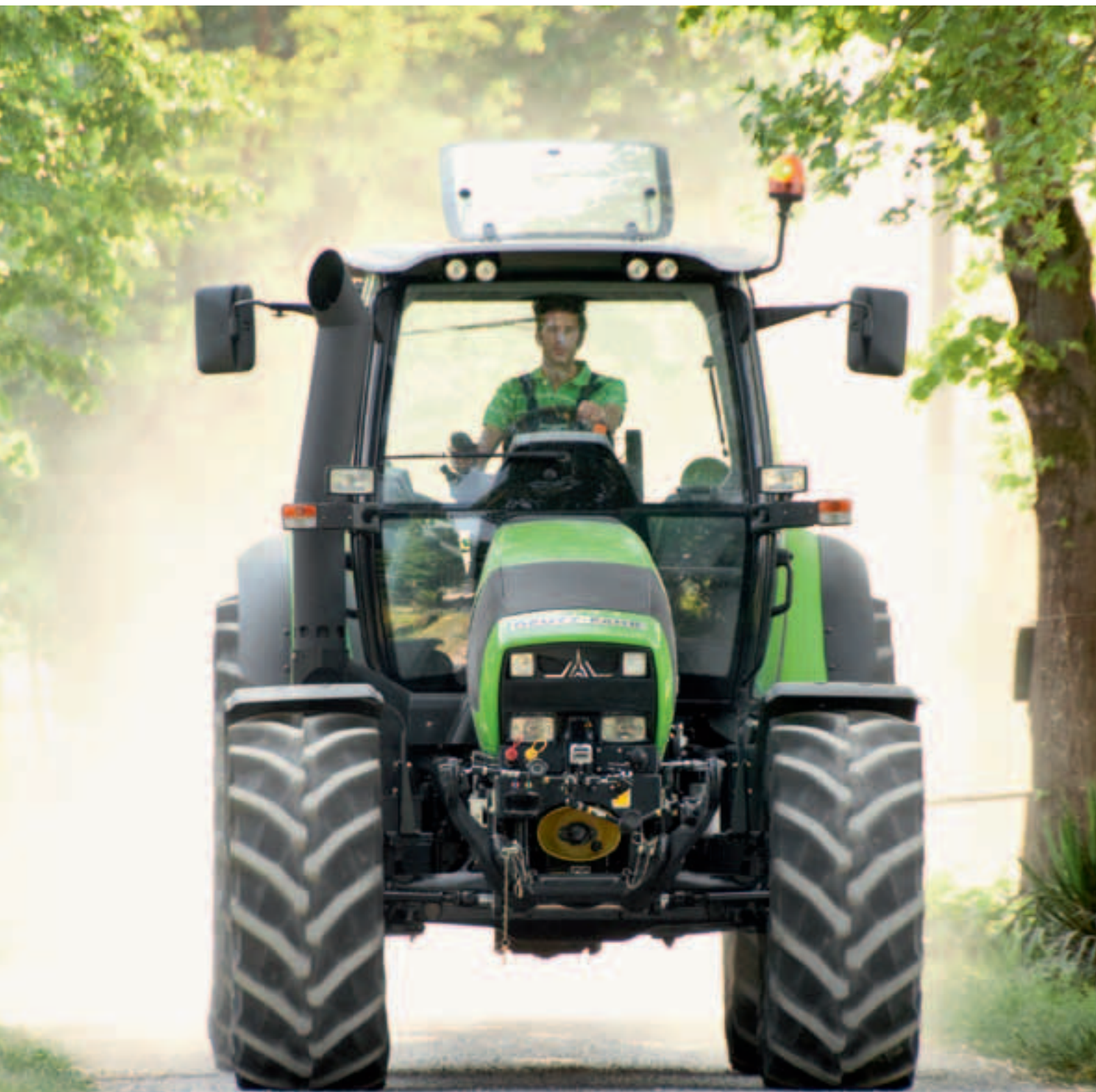
Le support oscillant, avec le point d'articulation sur la ligne médiane du pont, permet une oscillation de 22° pour compenser également les terrains les plus accidentés.
