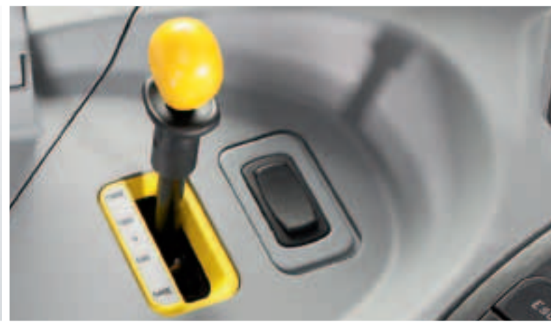
Il est facile de modifier la vitesse de la PDF grâce au levier jaune, à droite du poste de conduite.
