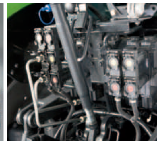
Jusqu'à 7 distributeurs hydrauliques pour un total de 10 voies arrière, 2 voies avant, meilleur contrôle du relevage avant.
