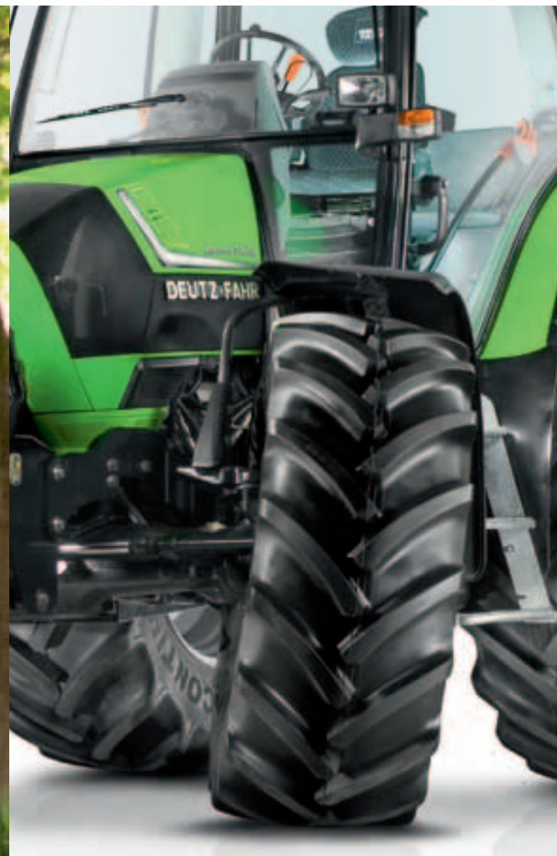
Le support oscillant, avec le point d'articulation sur la ligne médiane du pont, permet une oscillation de 22° pour compenser également les terrains les plus accidentés.
