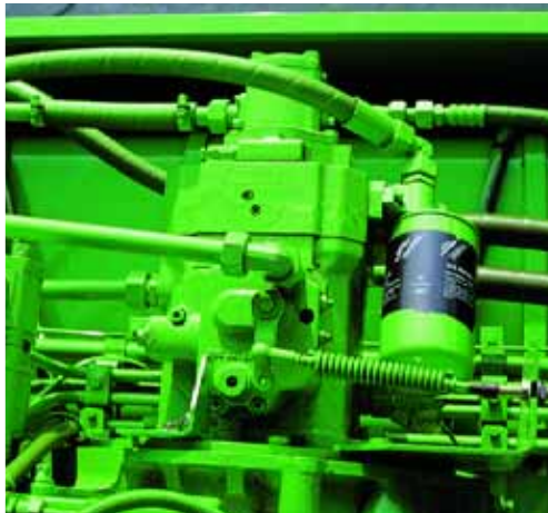
La pompe hydraulique d'avancement est bridée directement sur le moteur à gauche dans le sens de la marche.
