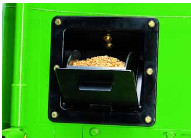
Trappe d'échantillon à portée de main du conducteur. Contrôle simple et pratique de la qualité de la récolte.
