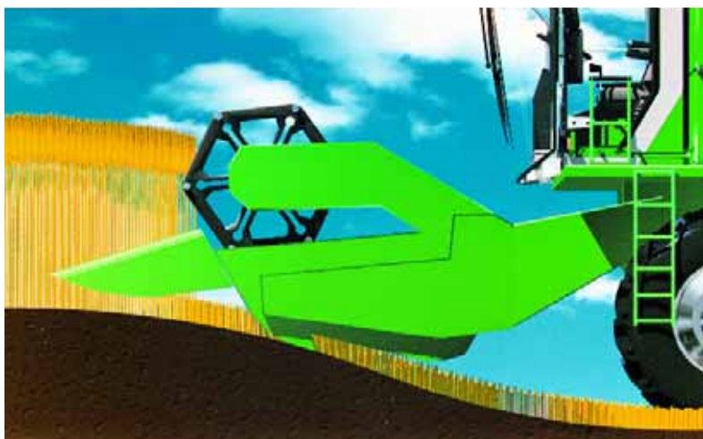
Correction automatique du niveau de coupe DEUTZ-FAHR: adaptation parfaite aux irrégularités du sol.
