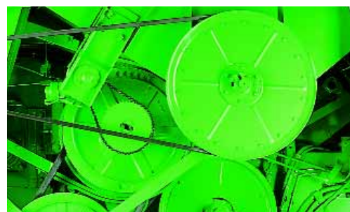
Le régime du batteur est ajustable à tout moment à partir du poste de conduite de 420 à 1250 tr/min.
