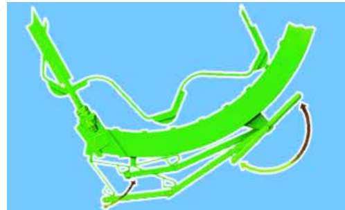
Les tôles d'ébarbage commandées de l'extérieur garantissent une grande qualité de travail.
