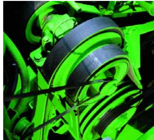
Du côté droit se trouvent les entraînements des différents organes de battage.
