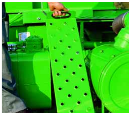
Une passerelle rabattable au dessus du moteur permet un accès rapide et sûr.
