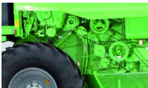
Une très grande trappe de visite de chaque côté facilite l'inspection du contre-batteur et de la table de préparation.
