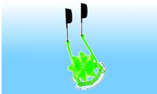
Il suffit de presser un bouton pendant la marche pour régler électriquement de manière simple, pratique et séparément l'écartement à l'entrée et la sortie du contre-batteur.
