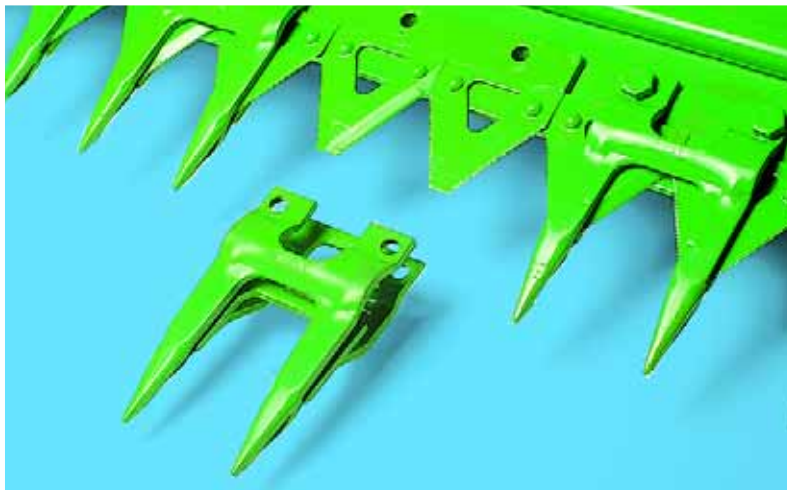
La partie tranchante des sections de la coupe tandem orientée alternativement vers le haut et le bas réduit l'usure et garantit toujours une bonne coupe.
