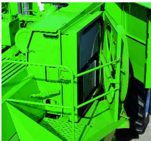
Accès optimal en laissant pivoter le tamis rotatif des radiateurs.
