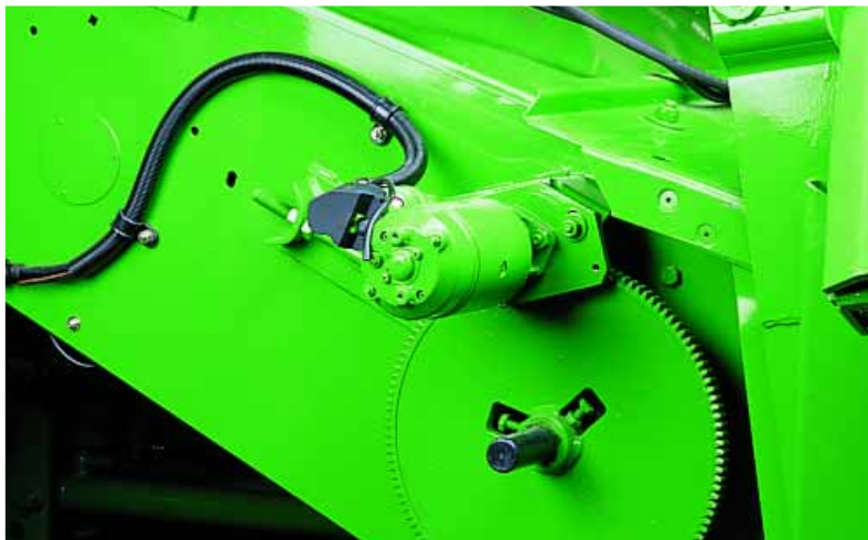
L'inverseur électrique du convoyeur rapide et efficace en cas de besoin.
