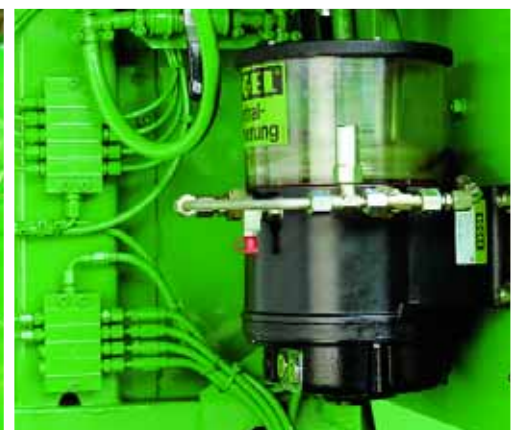
Un graissage centralisé automatique optionnel fait économiser beaucoup de temps. Un système de graissage centralisé manuel fait partie de l'équipement standard.
