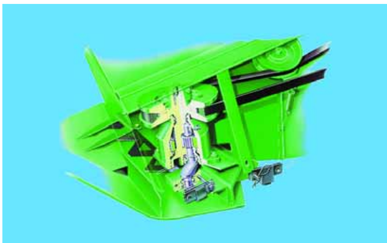
Le boîtier planétaire: assure une fréquence de coupe particulièrement élevée et une usure minimum.
