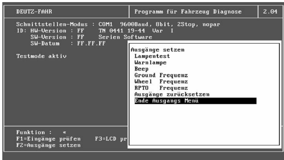
Fig. 57 - Fenêtre Set outputs
