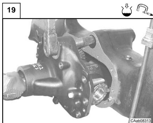
Poser le support du différentiel (10) sur la poutre d'essieu (1), en serrant les vis (11) et (15) au couple spécifié (voir C.8).
