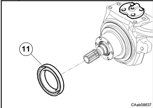
Déposer le cône du roulement (11) de l'arbre du porte-fusée (14) à l'aide d'un extracteur ordinaire.
