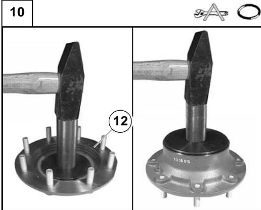
Chasser les cuvettes des roulements à rouleaux coniques (7) et (11) sur le moyeu de roue (10) à l'aide de l'outil spécial CA715291 et d'une presse ou d'un marteau.
