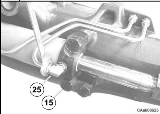
Déposer les raccords (25) des têtes de vérin de direction (15) et (20).
