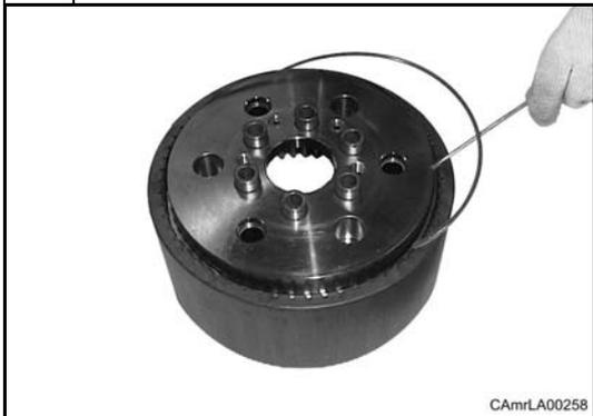
Déposer le circlip (9) et séparer le porte-couronne (8) de la couronne épicycloïdale (7).
