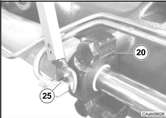
Introduire les raccords (25) dans les têtes de vérin de direction (15) et (20).
