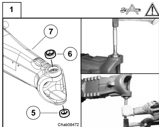
Refroidir la douille supérieure (6) et la cuvette (5) avec de l'azote liquide, à des températures inférieures à -100 °C.
