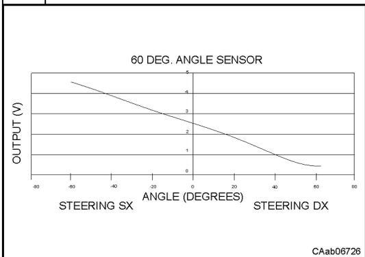
La position du capteur est correcte quand la tension en sortie du capteur est comprise dans la plage indiquée :
