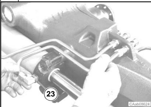
Fixer les conduites aux raccords (23) et (25) dans la poutre d'essieu et dans les têtes de vérin de direction.
