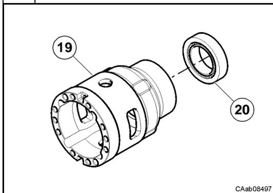
Poser la cuvette du roulement (20) sur le boîtier de différentiel (19) en utilisant le chasoir CA715583 et un marteau.
