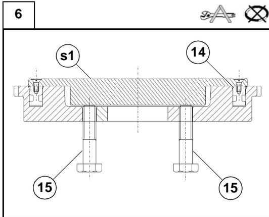
Pour déposer le piston de frein (14), monter l'outil spécial CA715492 (s1) et deux vis (15) déjà utilisées pour l'extraction du moyeu de couronne, comme le montre la figure.
