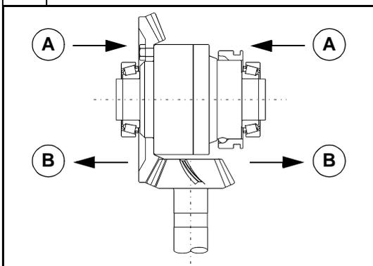
Si la mesure n'est pas comprise dans la plage spécifiée, bien contrôler l'assemblage de chaque pièce et corriger à l'aide des bagues de réglage (8) et (19) du support du différentiel :
