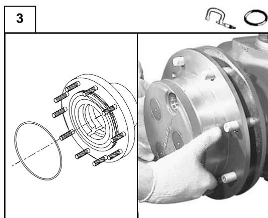
Introduire un joint torique neuf sur le train porte-satellites.
