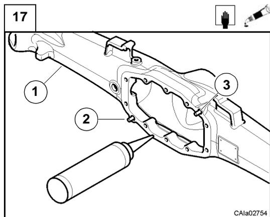
Avant de mettre en contact les surfaces usinées, vérifier l'absence d'impuretés et bien nettoyer à l'aide de produits détergents prévus à cet effet.
