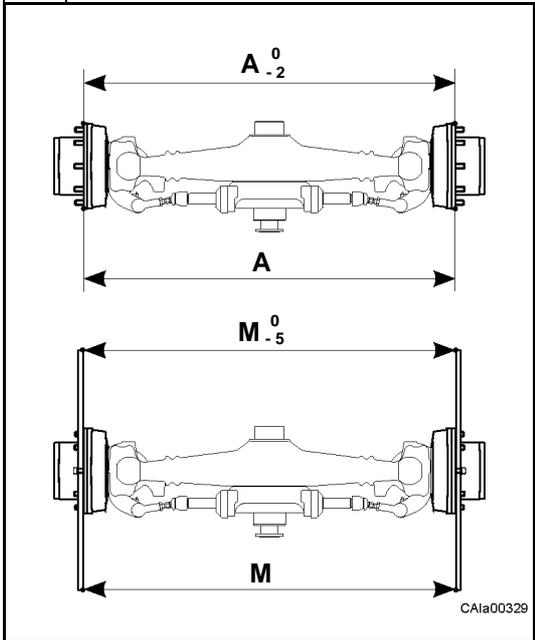
Vérifier que l'écart entre les mesures effectuées aux extrémités des diamètres des moyeux de roue est compris dans la plage de tolérance spécifiée.
