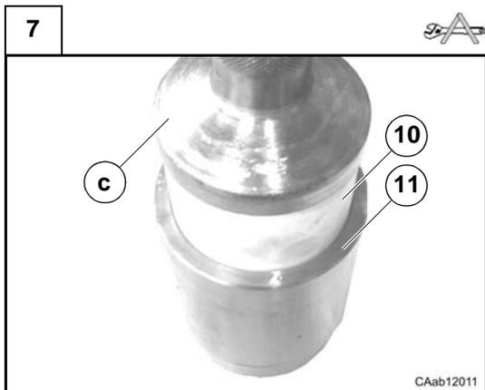
Poser la douille (10) dans la douille (11) à l'aide du chasoir CA715989 (c) et d'un marteau.
