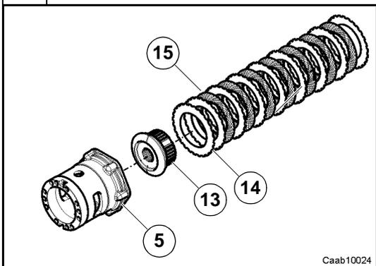
Déposer du boîtier de différentiel (5) : les plateaux presseurs (14), les disques de friction (15) et le train planétaire (13).
