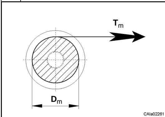
La précontrainte totale  $T_m$  est mesurée sur l'outil CA715706 (diamètre calibré  $D_m = 104,4$  mm).
