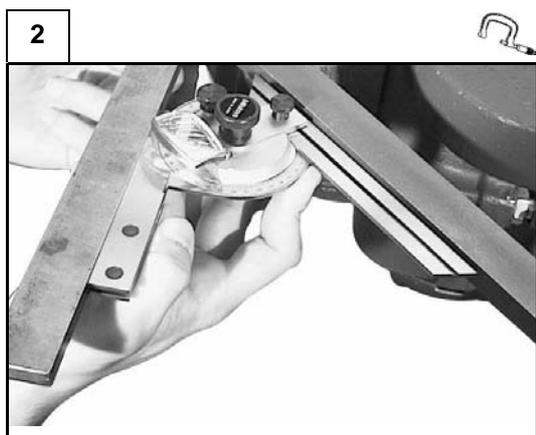
Régler un goniomètre sur l'angle requis (Sect. C.4) et le placer sur la barre longue.
