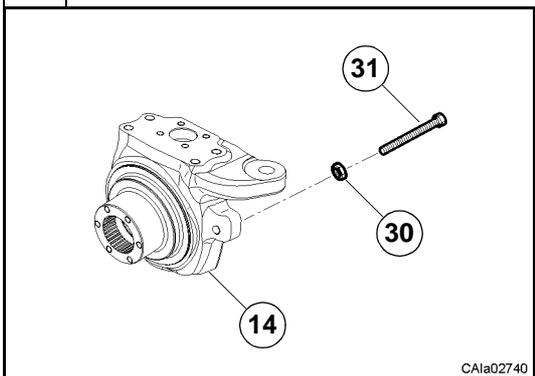
Si la butée mécanique de braquage a été déposée, reposer la vis (31) et l'écrou (30).
