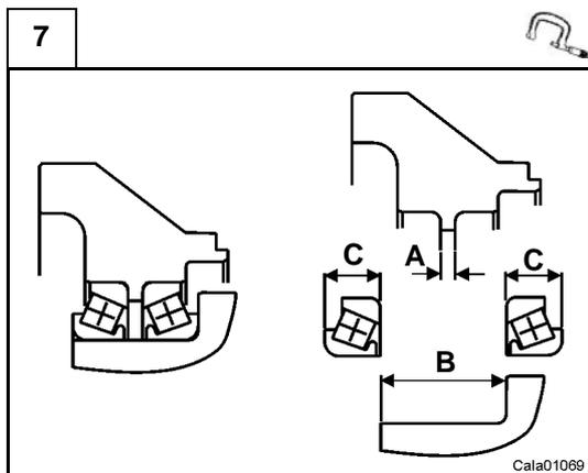
L'opération spéciale "Set Right" des roulements (7) et (11) ne nécessite pas de réglage particulier de la précontrainte ou du jeu. Quoi qu'il en soit, avant le montage de nouvelles pièces, contrôler que les cotes ci-dessous sont respectées.
