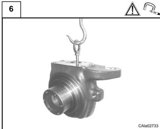
**Danger** : soutenir le porte-fusée (14) avec une courroie ou une élingue et un treuil ou autre appareil.
