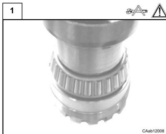
Poser le roulement (9) sur la bague de réglage (8) à l'aide du chasoir CA715093.
