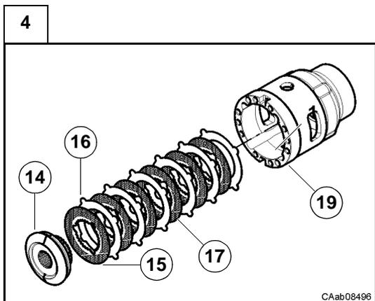
Sortir du boîtier de différentiel (19) : le train planétaire (14), le disque (15), les plateaux presseurs (16) et les disques (17).
