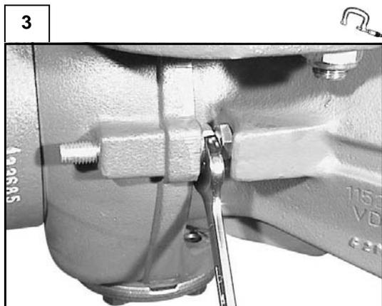
Régler la butée mécanique de braquage, en vissant ou dévissant les vis correspondante (4) et en les bloquant ensuite avec les contre-écrous (5) au couple de serrage spécifié (voir C.8).
