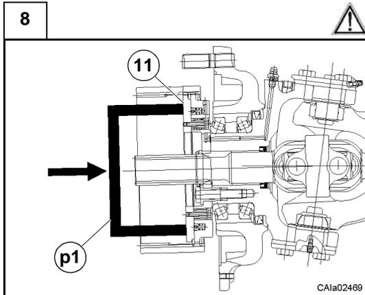
**Attention** : en cas de remplacement du disque de frein seul, pousser le plateau de pression (11) jusqu'en butée à l'aide d'un chasoir **p1** et d'un marteau.
