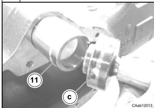
Poser dans la poutre d'essieu (7) la douille (11) à l'aide du chasoir CA715966 et d'un marteau.
