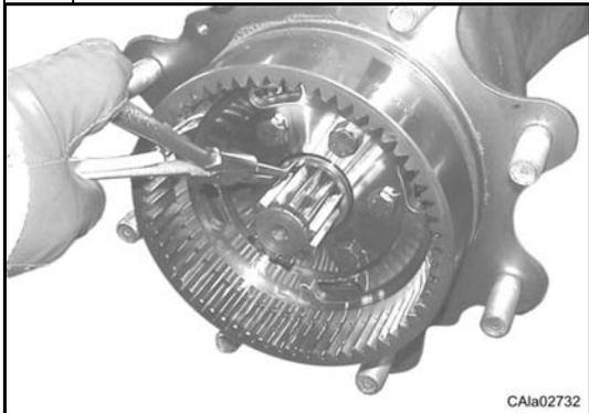
Déposer le circlip (1) de l'arbre de roue.
