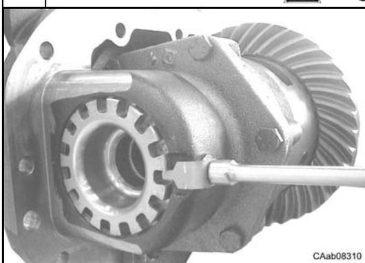
Après avoir terminé tous les réglages, poser les arrêts des bagues (6) et (21) avec les vis correspondantes (5) et (22) en les serrant au couple spécifié (voir C.8) à l'aide d'une clé dynamométrique.
