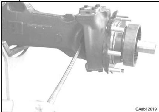
À l'aide d'un levier, pousser le double joint de cardan vers le moyeu de roue pour l'introduire dans l'outil CA715983.
