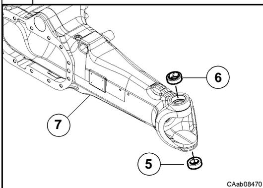
Si la douille (6) et le joint à rotule (5) sont usés, les extraire des logements des axes de fusée à l'aide d'un extracteur approprié.
