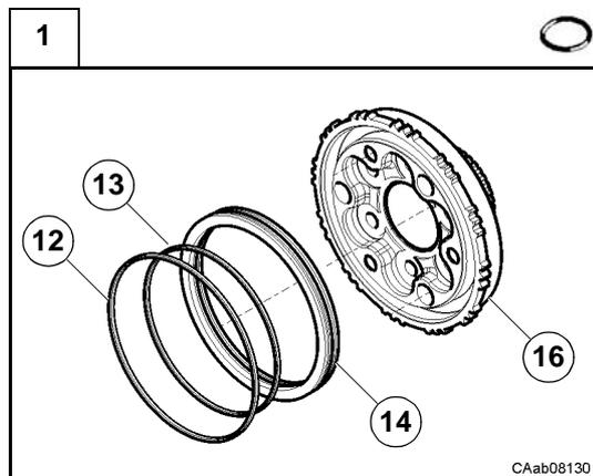
Poser les deux nouveaux joints QUAD-Ring (**12**, **13**) sur le piston (**14**). Introduire le piston (**14**) dans le moyeu de la couronne (**16**).
