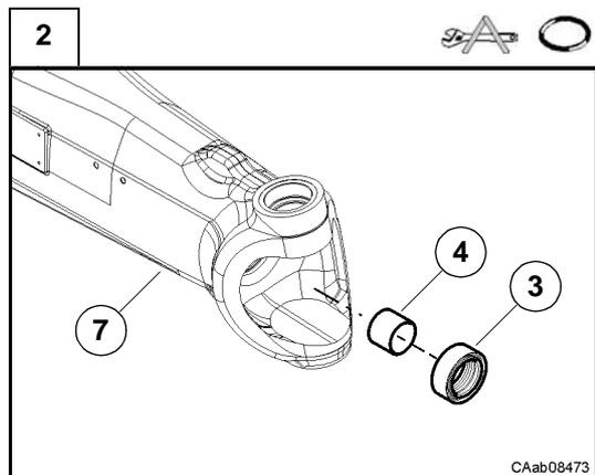
Poser dans la poutre d'essieu (7) la douille (4) à l'aide du chasoir CA715452 et d'un marteau.
