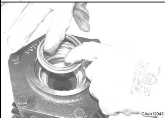
Lubrifier et reposer la bague d'étanchéité (23) sur le couvercle (21).
