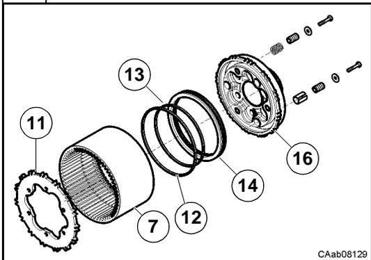
Démonter le plateau de pression (11) du moyeu de la couronne (16) après avoir ôté les vis du kit self-adjust.
