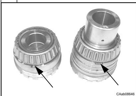
Déposer les cônes des roulements (9) et (16) en introduisant un levier dans les fentes indiquées.
