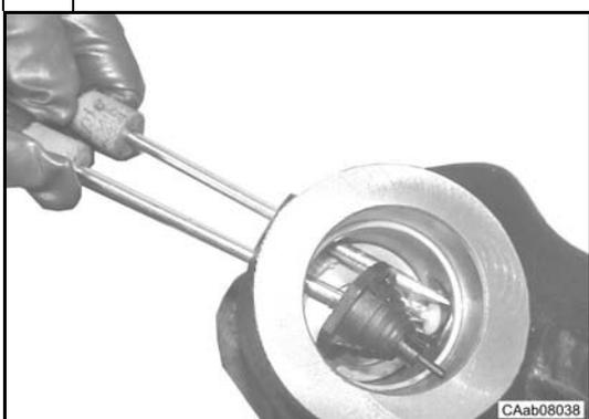
Installer la douille caoutchouc (12) et le capteur (10) dans leur logement.
