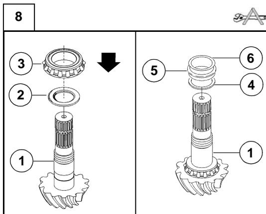
Après avoir posé la cale (2) de juste épaisseur, partie arrondie orientée vers l'engrenage, chasser le roulement (3) dans l'arbre du pignon (1) à l'aide d'une presse et du chassoir CA715004.
