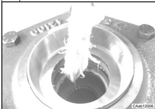
Lubrifier les lèvres des bagues d'étanchéité (23) et (27).
