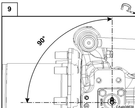
Poser les graisseurs (15) et (27) dans la position indiquée. Serrer les graisseurs au couple spécifié (Sect. C.8).
