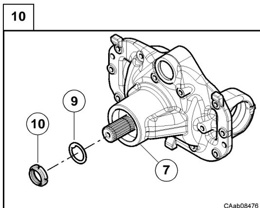
Introduire la rondelle d'arrêt de la bague (9) et visser une bague de serrage neuve (10) sur la queue de pignon.
