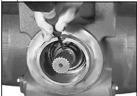
Quand la valeur de précontrainte est réglée, chanfreiner la bague (10) à l'aide d'un marteau et d'un poinçon.
