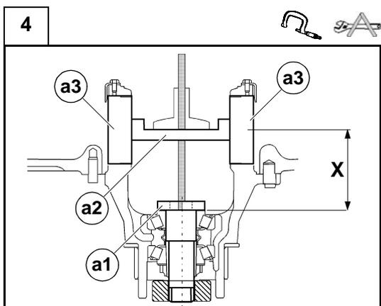
À l'aide d'une jauge de profondeur, mesurer la cote "**X**" (distance entre l'axe des roulements du boîtier de différentiel et la base d'appui de la tête du pignon).
