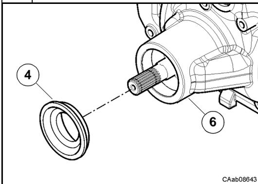
Déposer la bague d'étanchéité (4) du support du différentiel (6).
