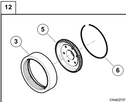
Prémonter le porte-couronne (5) et la couronne épicycloïdale (3) avec le circlip spécial (6) comme indiqué sur la figure.
