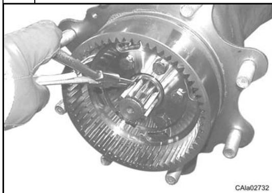
Poser le circlip (1) à l'extrémité du moyeu cannelé et le pousser dans son logement.
