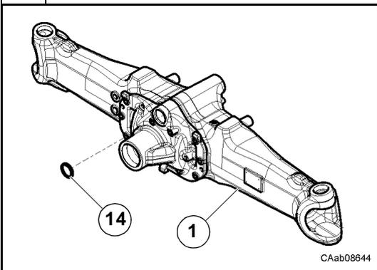
Poser une bague d'étanchéité neuve (14) dans la poutre d'essieu (1) à l'aide du chasoir CA715964 et d'un marteau.
