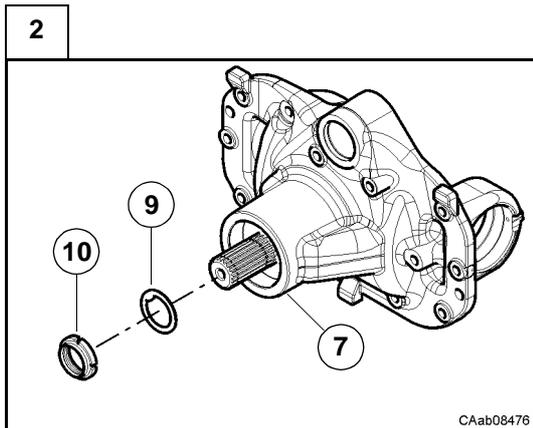
Déposer la bague (10) et récupérer la rondelle butée-bague (9).
