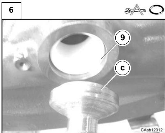
Poser la douille (9) dans la poutre d'essieu (7) à l'aide du chasoir CA715962 (c) et d'un marteau.
