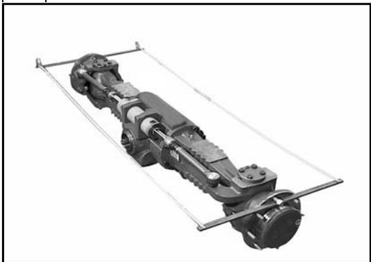
Prendre un mètre ruban et mesurer la distance en millimètres **M** entre les extrémités des piges.
