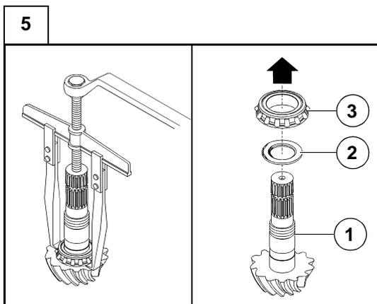
Pour déposer le cône du roulement à rouleaux coniques (3) du pignon conique (1), utiliser un extracteur ordinaire.
