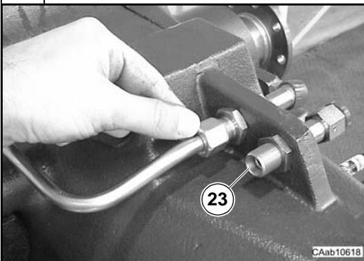
Déposer de la poutre d'essieu les conduites (24) et les raccords correspondants (23).
