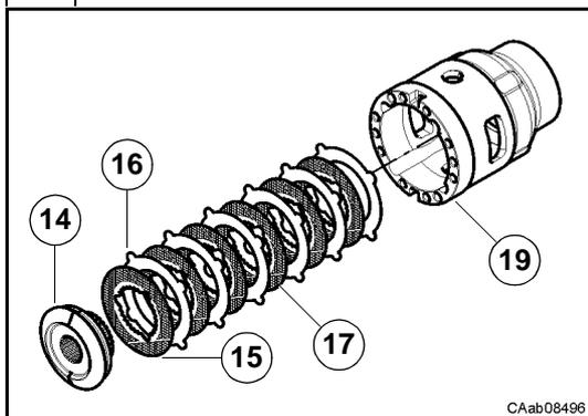
Introduire dans le boîtier de différentiel (19) les plateaux presseurs (16), les disques (17), le disque (15) et le train planétaire (14) comme le montre la figure.
