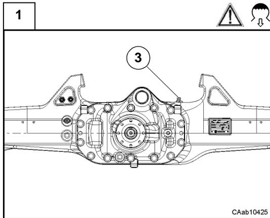
**Attention** : la vidange, le remplissage et le contrôle du niveau d'huile doivent toujours être effectués avec le pont horizontal.
