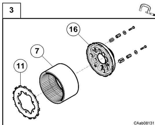
Assembler le plateau de pression (**11**) et la couronne épicycloïdale (**7**) au porte-couronne (**16**) avec le kit self-adjust (**18÷25**).
