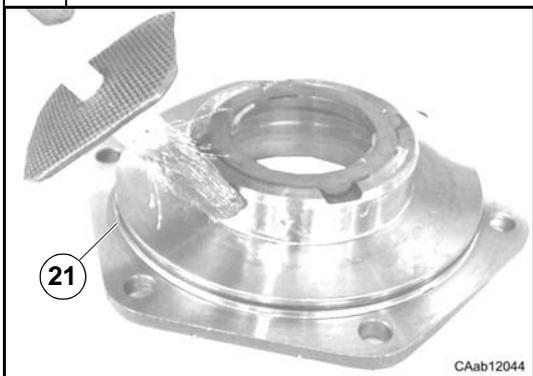
Lubrifier et poser un joint torique neuf (20) sur couvercle du boîtier de différentiel (21).
