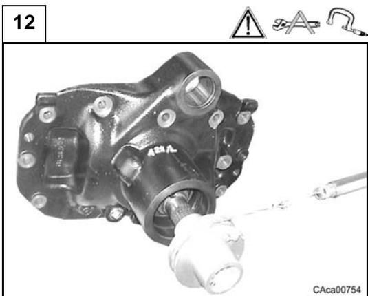
Pour mesurer la précontrainte  $P_m$  des roulements coniques (3) et (8), utiliser un dynamomètre en enroulant un cordon autour de l'outil CA715706 inséré sur la queue de pignon (1).
