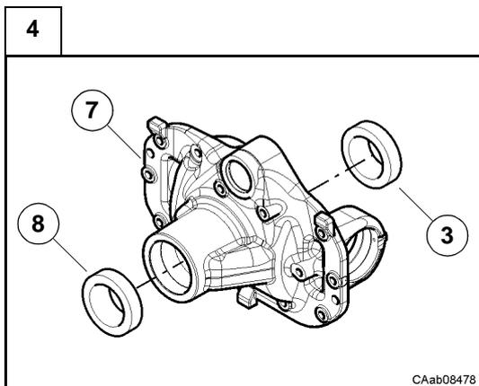
Déposer les cuvettes de roulement (3) et (8) du support du différentiel (7) à l'aide d'un chasoir et d'un marteau.
