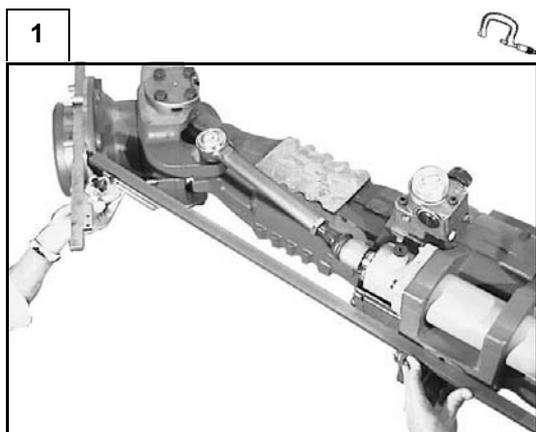
Utiliser les mêmes piges que pour le réglage du pincement et mettre une barre longue parfaitement en appui sur la partie usinée du corps central (côté pignon) de façon à ce que les deux piges forment un angle aigu quand le braquage est maximum.
