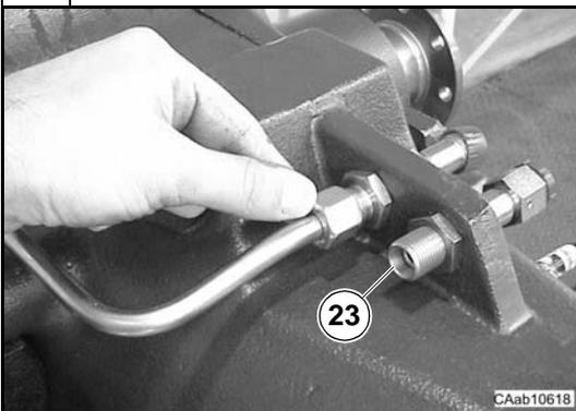
Introduire les raccords (23) dans la poutre d'essieu et les serrer au couple spécifié (Sect. C.8).
