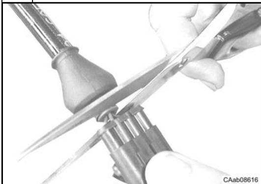
Couper les fils électriques (13) du côté du connecteur (17) et récupérer la douille caoutchouc (14).
