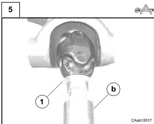
Poser le couvercle de protection (1) côté demi-arbre court sur le double joint de cardan à l'aide du chasoir CA715988 (b).
