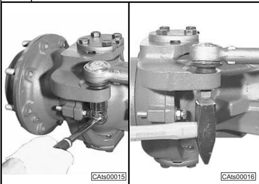
Desserrer de quelques tours les écrous (10) et (12) de fixation des bielles de direction jusqu'à l'extrémité de la tige filetée.
