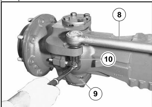
Remettre le joint à rotule du tirant (8) en place sur le porte-fusée (9).
