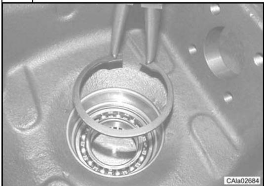
Poser le circlip (28) dans le porte-fusée (14).
