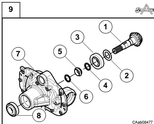
Introduire le groupe pignon conique (1) préassemblé dans le support du différentiel (7) et le cône du roulement (8) sur la queue de pignon, comme le montre la figure.
