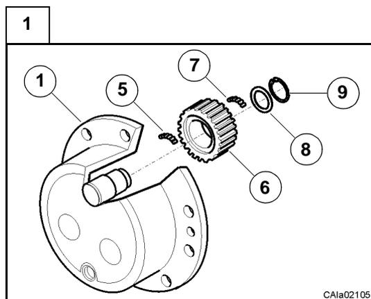
Récupérer tous les composants du train épicycloïdal : le porte-satellites (1), le circlip (9), la rondelle de butée (8), les pignons (6) et les roulements à aiguilles correspondants (5) et (7).
