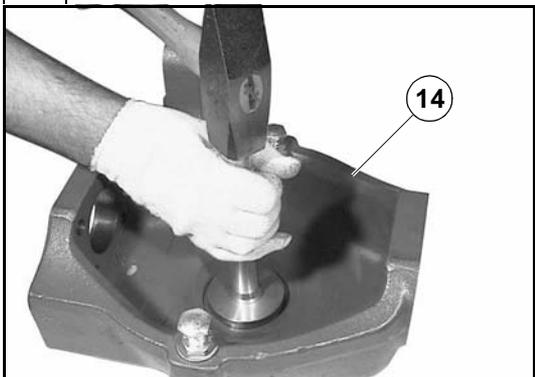
Poser la bague d'étanchéité (29) dans le porte-fusée (14) à l'aide du chasoir CA715986 et d'un marteau.
