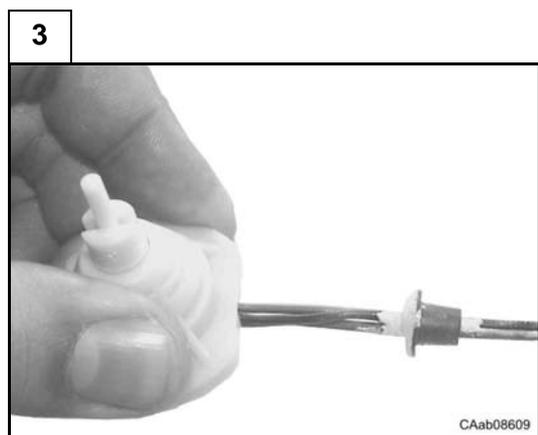
Reposer la douille caoutchouc (12) sur les nouveaux fils électriques (13).
