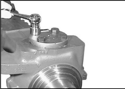
Dévisser et ôter les vis de fixation (19) et (26) de l'axe de fusée supérieur (20) et inférieur (25).
