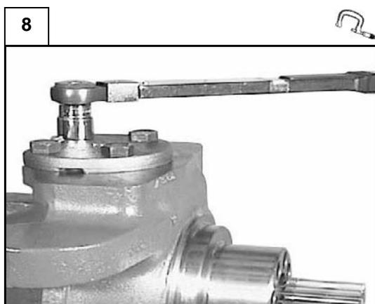
Poser les axes de fusée inférieur (25) et supérieur (20) puis serrer les vis (26) et (19) au couple spécifié (Sect. C.8).
