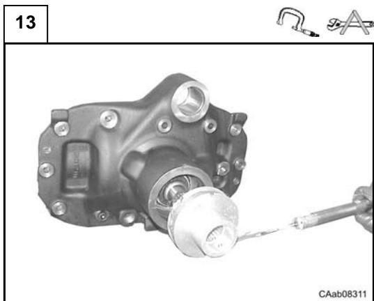
Une fois le jeu pignon-couronne établi, mesurer la précontrainte totale  $T_m$  des roulements (système pignon-couronne) en utilisant un dynamomètre avec un cordon enroulé sur l'outil CA715706 inséré sur la queue cannelée du pignon.
