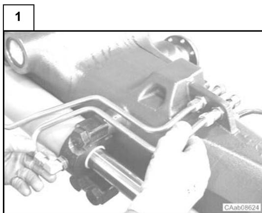
Débrancher les conduites des raccords (23) et (25) dans la poutre d'essieu et dans les têtes de vérin de direction.
