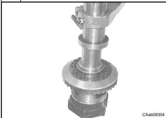
Poser la cuvette du roulement (1) à l'aide du chassoir CA715583.
