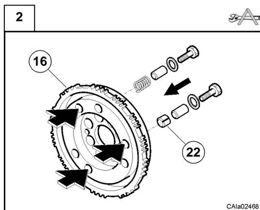
À l'aide de l'outil spécial CA715033, pousser les douilles (**22**) dans les logements du porte-couronne (**16**) jusqu'au ras du plan d'appui interne du plateau de pression (**11**).
