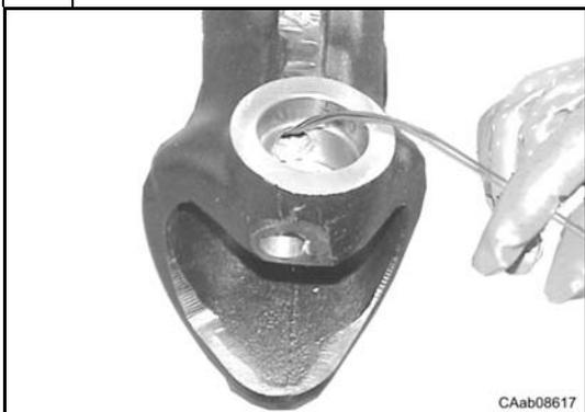
Introduire les trois fils électriques(13) dans la gaine (18) à l'intérieur du pont.
