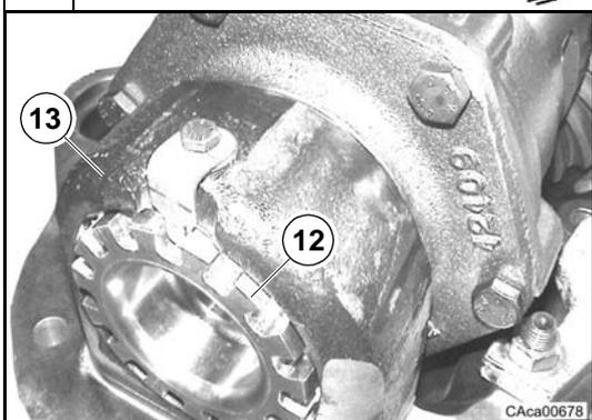
Avant de déposer les bagues (8) et (19), faire des marques indélébiles sur les bagues et le support du différentiel (10) afin d'éviter de les intervertir lors de la repose.
