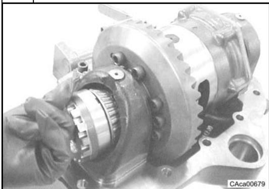
Introduire la bague de réglage (8) dans le support du différentiel (10), côté couronne conique.
