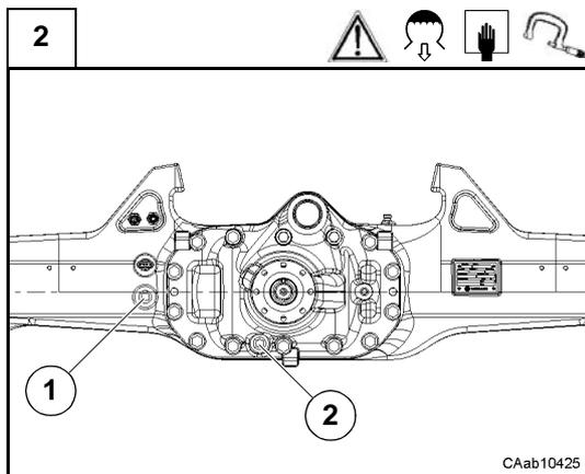
Pour vidanger l'huile du corps central, dévisser d'abord le bouchon de niveau (1), puis le bouchon de vidange (2).
