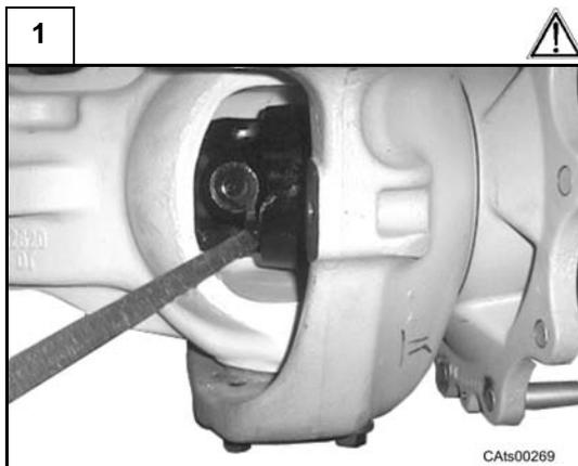
Introduire un levier entre le porte-fusée (14) et la poutre d'essieu et l'encastrer dans le double joint de cardan.
