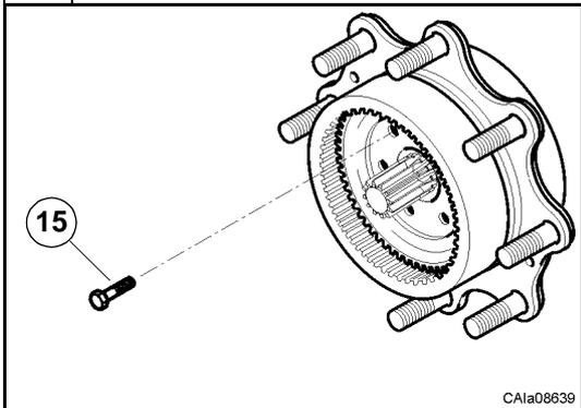
Visser les vis (15) jusqu'à ce que le porte-couronne (16) soit au contact du moyeu de roue (10).
