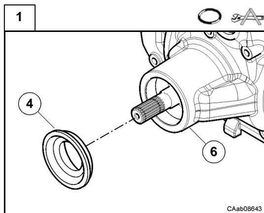
Reposer une bague d'étanchéité neuve (4) dans le support du différentiel (6) à l'aide du chassoir CA119148 et d'un marteau.
