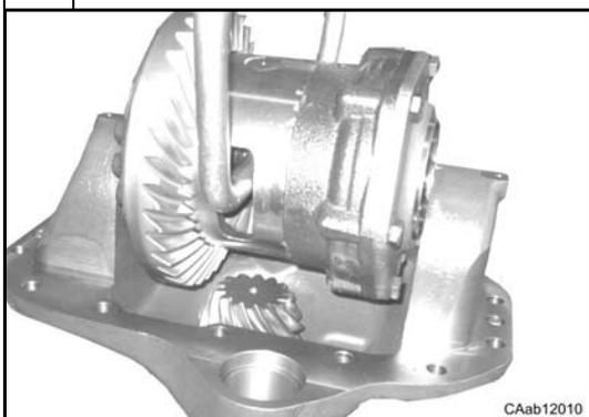
Déposer le boîtier de différentiel (4).
