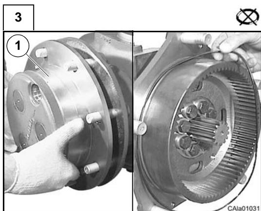
Déposer le porte-satellites (1) du moyeu de roue et récupérer le joint torique.
