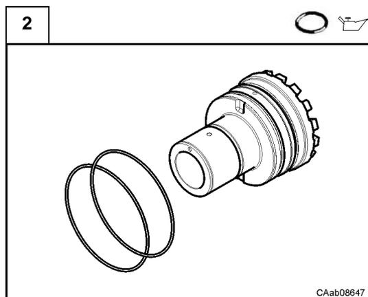
Lubrifier et poser les joints toriques (17) et (18) sur la bague de réglage (19).
