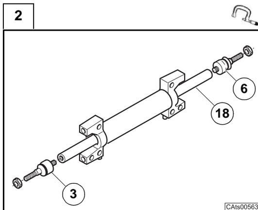
Poser les rotules (3) et (6) aux extrémité de la tige (18) du vérin en les serrant au couple spécifié à l'aide d'une clé dynamométrique (Sect. C.8).
