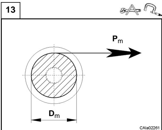
La précontrainte effective  $P_m$  est mesurée par l'outil CA715706 (diamètre calibré  $D_m = 104,4$  mm).
