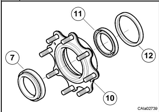
Poser le moyeu de roue (10) sur un plan de travail et extraire la bague d'étanchéité (12) à l'aide d'un levier.
