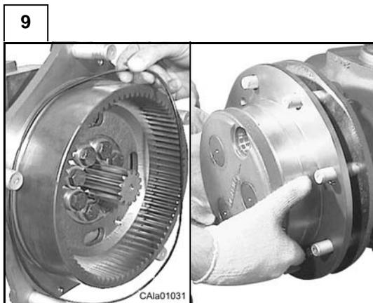
Assembler le porte-satellites au moyeu de roue.
