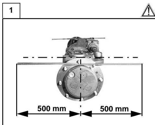
Poser 2 piges identiques d'un mètre de longueur sur les côtés des roues, en les bloquant avec deux écrous, sur les goujons du moyeu de roue.
