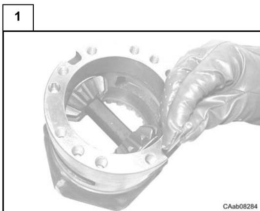
Poser l'arbre (9), les pignons satellites (8) et (11), les rondelles de butée (7) et (12) dans le boîtier de différentiel (6).
