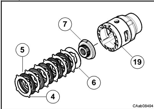
Introduire dans le boîtier de différentiel (19) le train planétaire (7), le disque (6), les plateaux presseurs (4) et les disques (5) comme le montre la figure.
