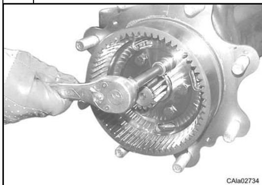
Serrer les vis de fixation (4) au couple spécifié (Sect. C.8).
