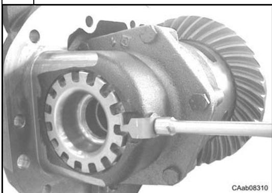
Ôter les vis (5) et (22) pour déposer les arrêts de bagues (6) et (21).
