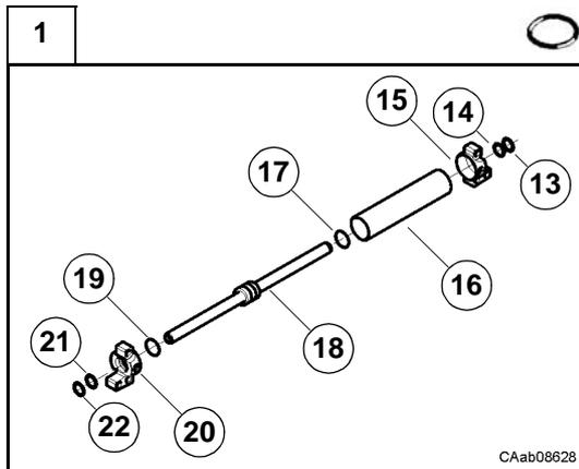
Poser des bagues d'étanchéité neuves (13, 14, 17, 19, 21 et 22) sur la tige (18) et sur les têtes de vérin (15) et (20).
