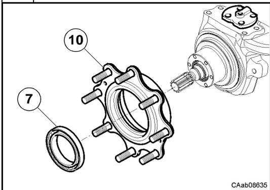
Extraire le moyeu de roue (10) en facilitant l'extraction à l'aide de leviers et d'un marteau.
