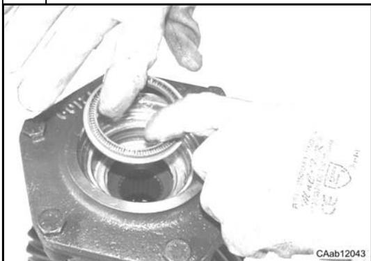
Déposer la bague d'étanchéité (23).
