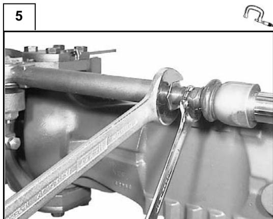
Une fois le réglage terminé, visser les écrous de blocage (2) des tringles de guidage (1) au couple de serrage spécifié (voir C.8).
