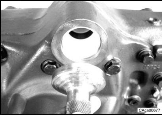
Poser dans la poutre d'essieu (1) la douille (13) à l'aide du chasoir CA715962 et d'un marteau.
