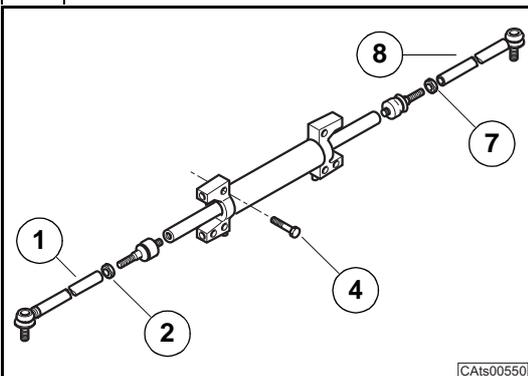
Déposer les tirants (1) et (8) de la bielle de direction en desserrant les écrous de blocage (2) et (7), puis contrôler leur état.
