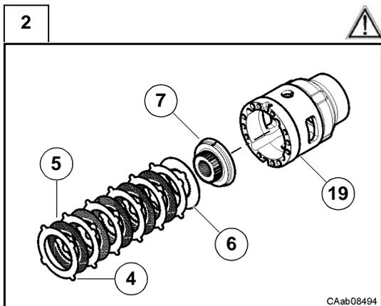
Récupérer les plateaux presseurs (4), les disques de friction (5) et (6) et le train planétaire (7).
