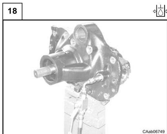
Envoyer de l'huile à la pression de 13÷15 bar par l'orifice d'engagement du différentiel (voir C.5) pendant une durée de 3 minutes et vérifier l'absence de fuites d'huile.
