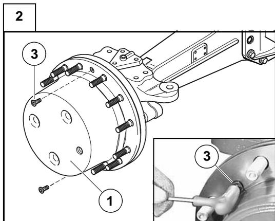
À l'aide d'un clé ordinaire, dévisser et ôter les deux vis de fixation (3) du porte-satellites (1).
