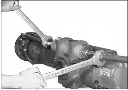
Si le pincement est incorrect, intervenir sur les tringles de guidage (1) à l'aide de deux clés, en vissant et dévissant les deux tirants (3) de la même longueur, jusqu'à obtenir un pincement correct.
