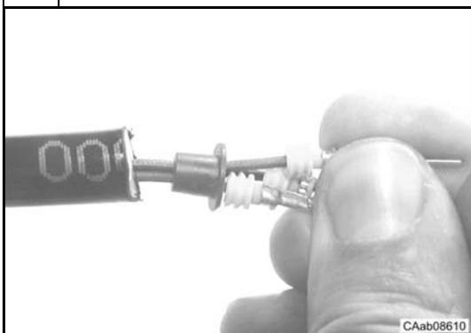
Reposer la douille caoutchouc (14) sur les câbles (13).
