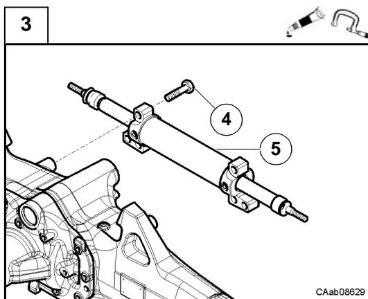
Appliquer du frein-filet indiqué (Sect. C.7) sur le filetage des vis (4). Remettre les vis de fixation (4) des têtes de vérin de direction (15) et (20) et les serrer au couple spécifié (Sect. C.8).
