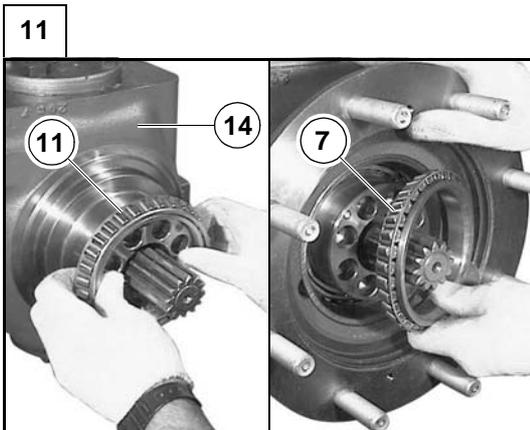
Poser le cône du roulement à rouleaux coniques (11) sur l'arbre du porte-fusée (14).
