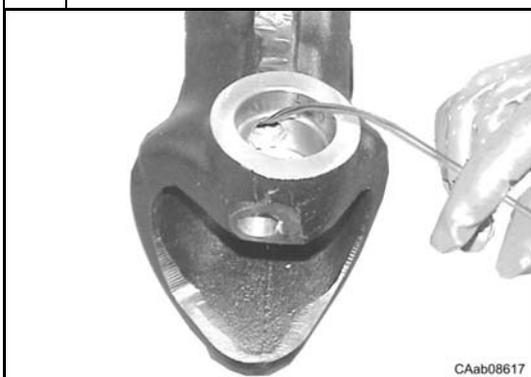
Extraire les fils du capteur (13) et récupérer la douille caoutchouc (12).
