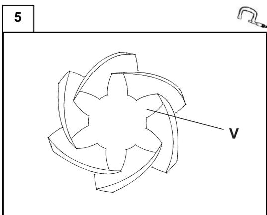
Pour déterminer l'épaisseur (**S**) de la cale à placer entre le pignon et le roulement, retrancher de la valeur (**X**) mesurée la valeur (**V**) gravée sur la tête du pignon (**V**=distance prescrite).
