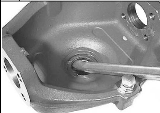
Placer le porte-fusée (14) sur un plan de travail et extraire la bague d'étanchéité (29) à l'aide d'un levier.
