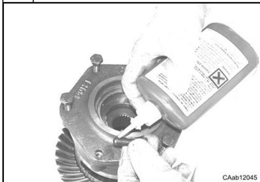
Appliquer de la pâte à joint du type spécifié (voir C.7) sur les vis de fixation (22).
