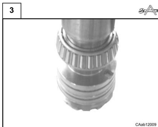
Poser le roulement (16) sur la bague de réglage (19) à l'aide du chasoir CA715093.
