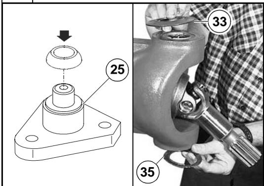
Si le cône du joint à rotule a été déposé, le reposer sur le pivot de fusée inférieur (25) à l'aide de l'outil CA715035 et d'une presse
