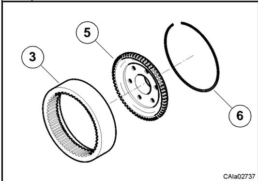
Déposer le circlip en acier (6) et séparer le porte-couronne (5) de la couronne épicycloïdale (3).
