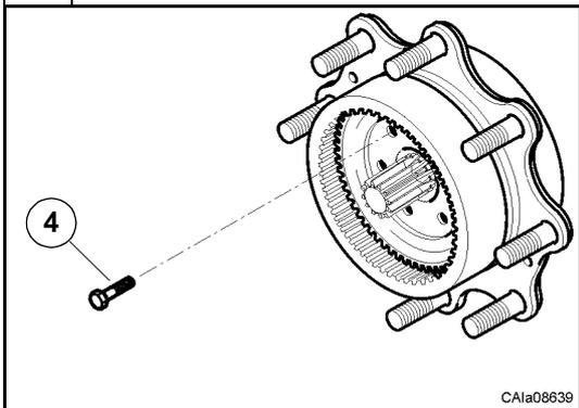
Visser les vis (4) jusqu'à ce que le porte-couronne (5) soit au contact du moyeu de roue (10).
