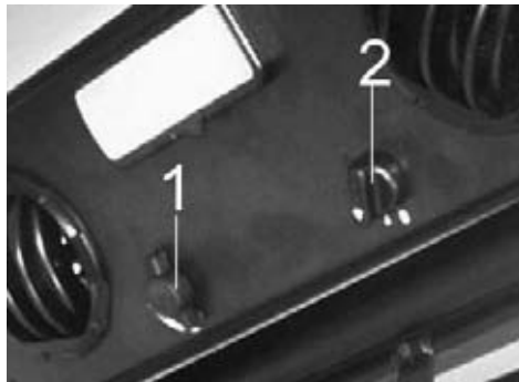
Fig. 4 - Commande de ventilation et chauffage
