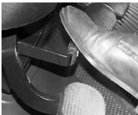
Pour ajuster l'inclinaison du volant longitudinalement, tirer vers le bas le levier, puis mettre le volant dans la position recherchée et tirer le levier vers le haut pour bloquer le volant.
