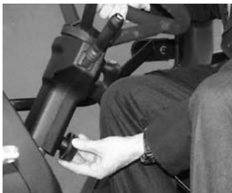
En outre, la colonne de direction est de type télescopique pour permettre le réglage en hauteur du volant.
