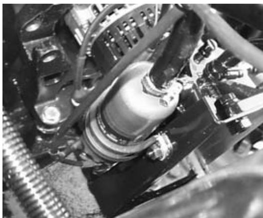
Pour actionner la pompe de carburant, tourner la clé de contact sur 1. Dès que la pression maximale admissible de l'installation est atteinte, le carburant est reconduit dans le réservoir via une soupape.
