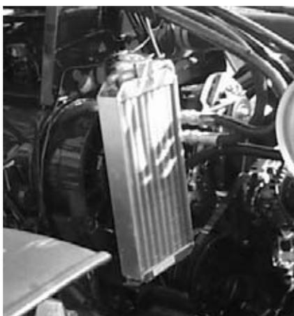
Le nettoyage peut s'effectuer avec un jet d'air comprimé et, si nécessaire, aussi avec un jet de vapeur (6 bars maximum) ou d'eau.
