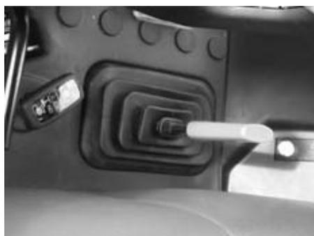
Pour la sélection des régimes 540/750/1000 tr/min, agir sur le levier situé à gauche derrière le siège du conducteur en respectant les indications de la plaquette apposée sous la fenêtre latérale gauche.
