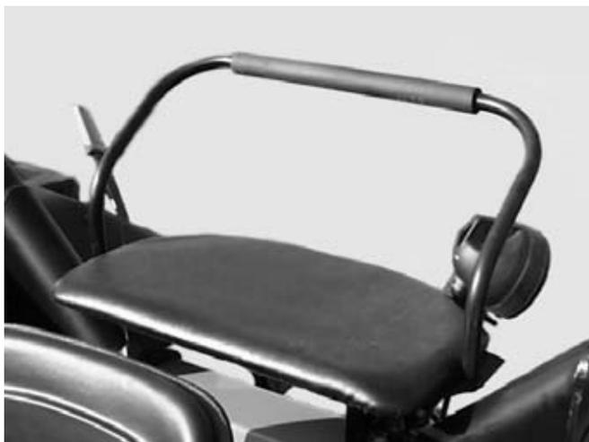
Siège deuxième conducteur (Tracteur avec plate-forme)
