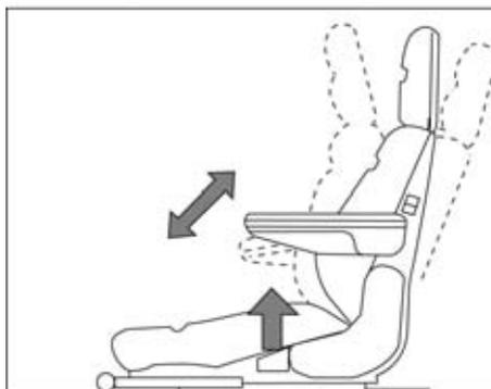
**3 - Réglage longitudinal du siège**
