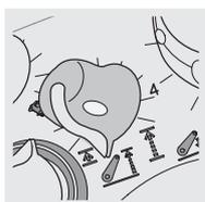
Permet de limiter la hauteur de montée maximum des bras de relevage au moment de la commande de montée.
