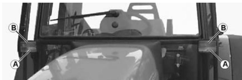
Les signalisations de position et d'indication de direction sont réalisées par deux ampoules distinctes : ***A*** - feux de position et ***B*** - feux indicateurs de direction (ou clignotants), renfermés dans un boîtier positionné sur chaque côté du tracteur.
