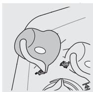
Permet de régler la vitesse de descente des bras de relevage.
