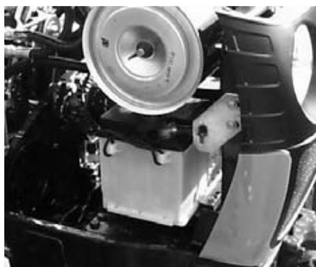
Après que vous ayez effectué les contrôles nécessaires, procédez au remontage en veillant à brancher d'abord le câble d'alimentation puis la tresse de masse.
