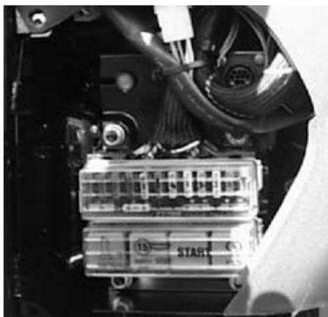
L'équipement électrique est protégé par des fusibles groupés dans une boîte en plastique placée à gauche sur le tableau de bord. Lorsqu'un élément ne fonctionne pas, vérifiez le fusible correspondant, et éventuellement le remplacer. En cas d'interruption inattendue, remplacez momentanément le fusible d'un élément essentiel (par exemple un phare), par un autre moins important. Avant toute intervention sur la boîte à fusibles ou sur les relais, coupez toujours l'alimentation.
