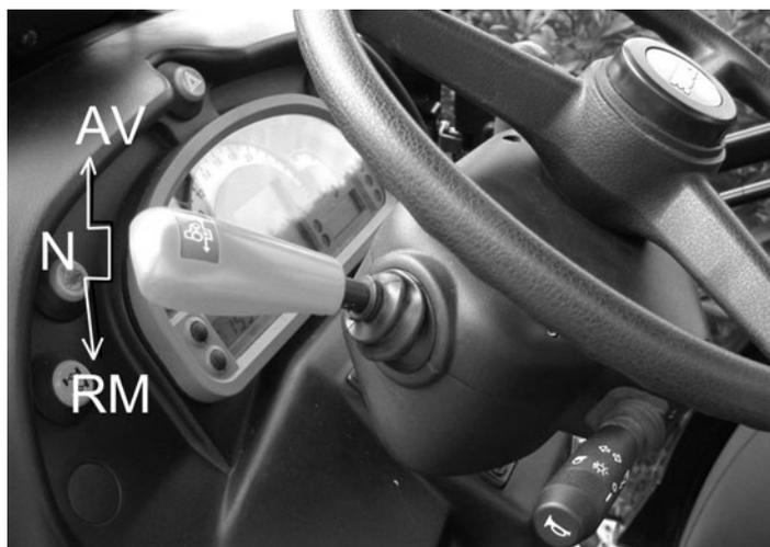
Levier de commande au volant de l'inverseur hydraulique
