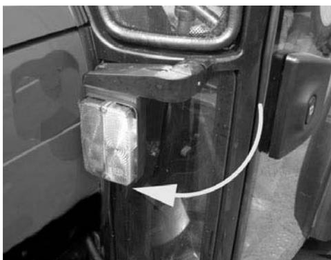
Dans les travaux ou la présence de végétation peut créer des obstacles, le support des feux peut être tourné vers l'intérieur (comme représenté sur la figure ci-contre) pour éviter, par exemple, que des branches se prennent dans celui-ci.
