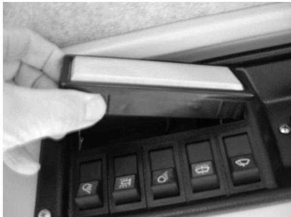
Pour le remplacement de l'ampoule, sortir le corps du plafonnier en le tirant vers l'extérieur.
