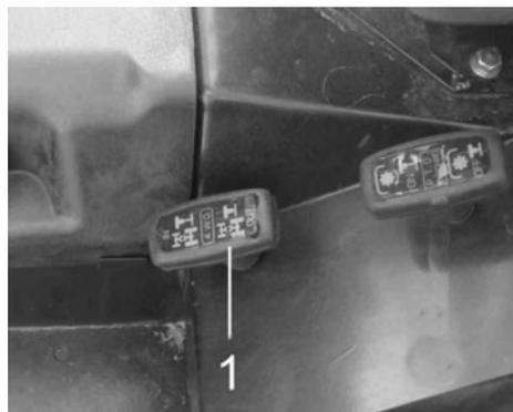
La traction avant peut être équipé (sur demande) de blocage de différentiel.
