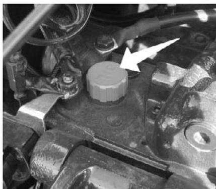
**REMARQUE:** Pendant le contrôle du niveau d'huile ou la vidange d'huile, garer le tracteur sur une aire horizontale ou plane.
