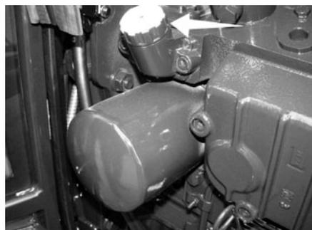
Réajustez le niveau si nécessaire. Pour ce faire, dévissez le bouchon de remplissage et faites l'appoint en utilisant de l'huile de la qualité préconisée.
