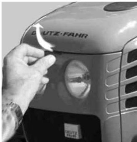
Le capot frontal basculant facilite l'accès pour l'entretien du moteur.
