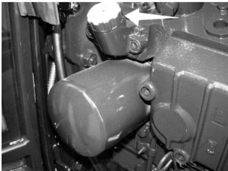
Controle el nivel del líquido refrigerante del motor.
