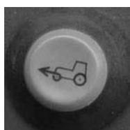
le traction avant est obtenu par bouton, qui est pressé il reste bloqué et la lampe-témoin dont il est pourvu s'allume.
