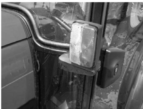
Pour les tracteurs équipés d'une cabine, les feux de position avant situés sur l'aile sont fixés à un support mobile.
