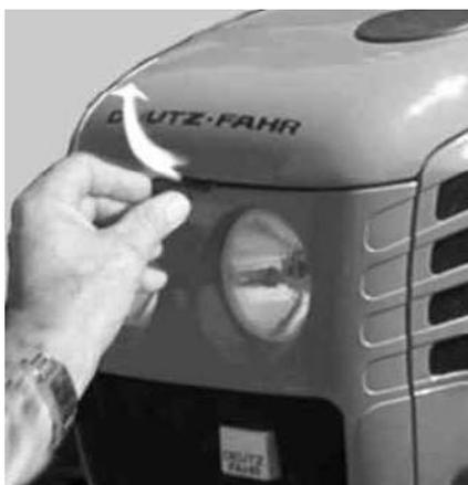
Pressez la commande de déverrouillage placée à l'avant, puis levez le capot jusqu'à la verticale et placez la béquille dans son ancrage.
