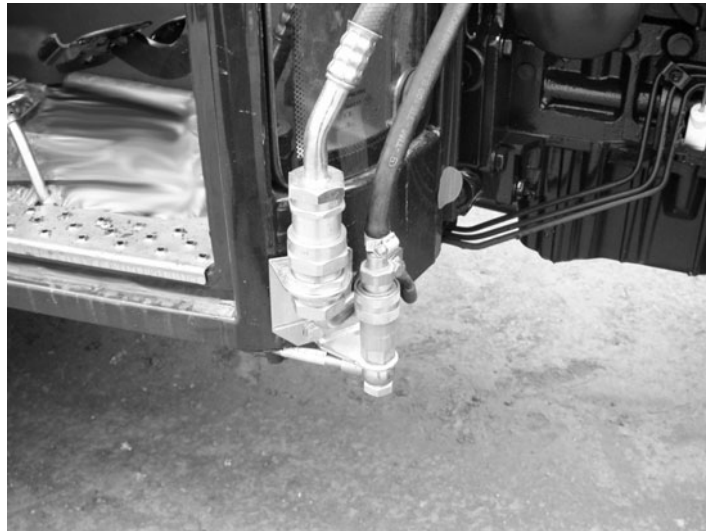
Clapets ou soupapes pour la recharge et l'entretien de l'installation du conditionnement d'air
