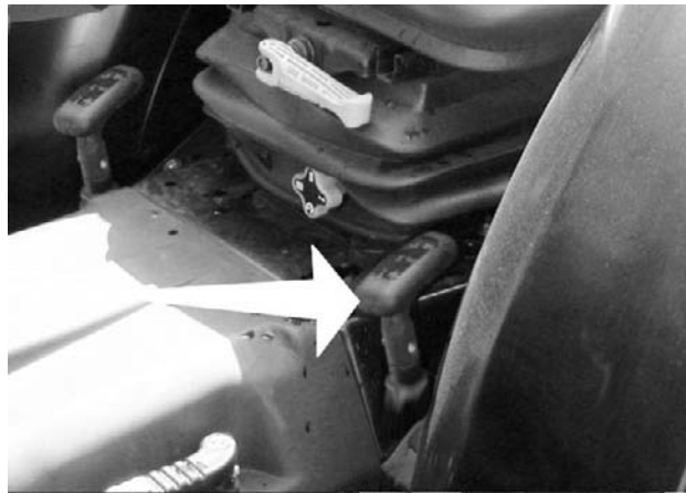
Levier de vitesses.: Versione avec minireducteur (pour tracteur sans Powershift)
