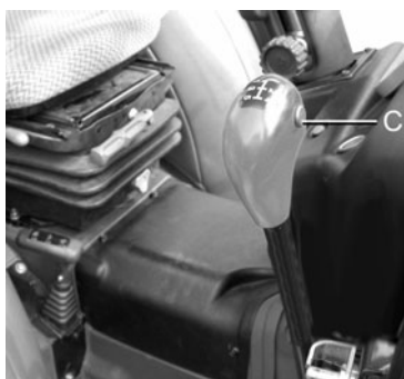
Levier de vitesses pour tracteurs avec mini réducteur C - Bouton embrayage automatique
