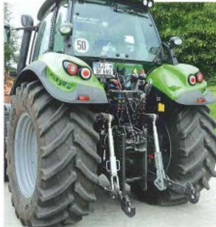
*La capacité de relevage est toujours suffisante, mais les connecteurs d'huile pourraient être mieux identifiés, de même que les crochets d'attelage à l'arrière.*
